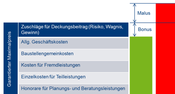
Abbildung 1 Funktionsweise GMB nach [21]
