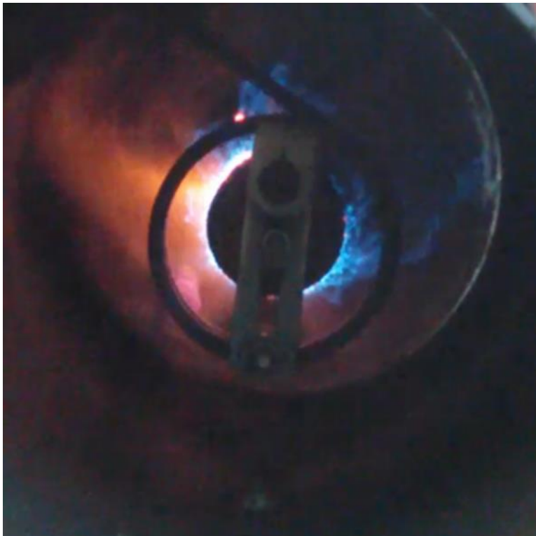
Bild 85: Darstellung der Verbrennung mit Stahlgewebeeinbau
