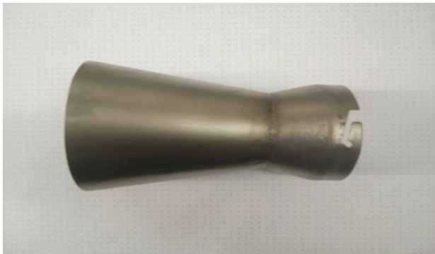
Bild 18: Formoptimiertes Flammenrohr mit düsenförmiger Einschnürung
