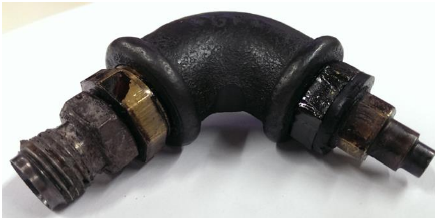
Bild 81: Gasdüse zur Öldampfeinleitung
