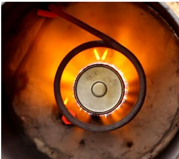
Bild 70: Öldampfversuch - Flammenbild, -färbung und -länge
