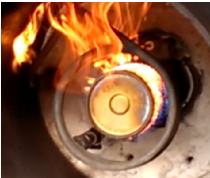
Bild 75: Durchmischung bei Einsatz eines Drallkörpers
