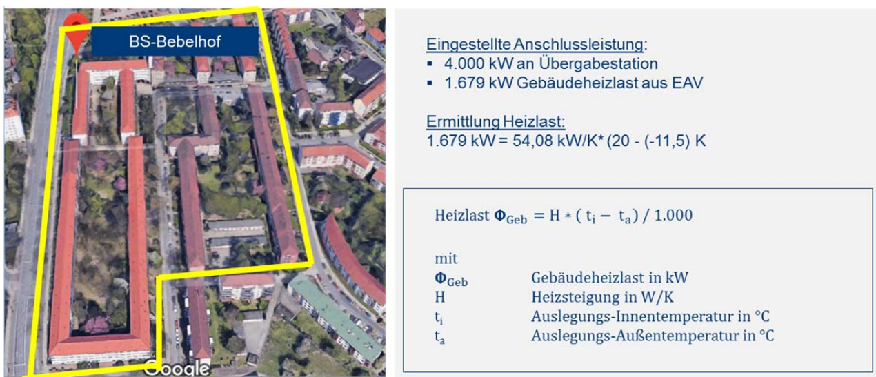
Abbildung 73 Berechnung Gebäudeheizlast aus EAV-Heizsteigung
