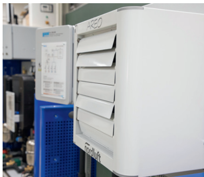
Versuchsstand Wärmepumpe mit Wasser-Luft-Wärmeüberträger
