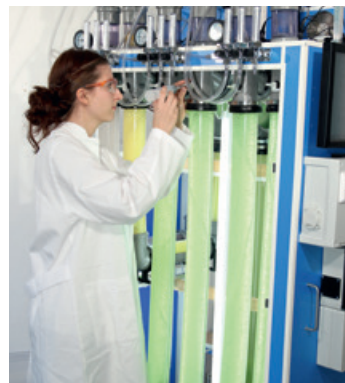
Algenkultivierung im Airlift-Reaktor
