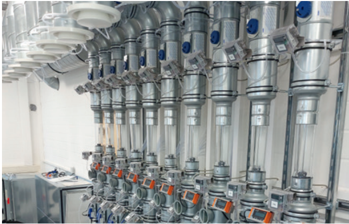
Versuchsstand zum Abgleich von Kanalnetzen und zur Programmierung und Erprobung von Regelstrategien für volumenvariable Mehrzonenanlagen
