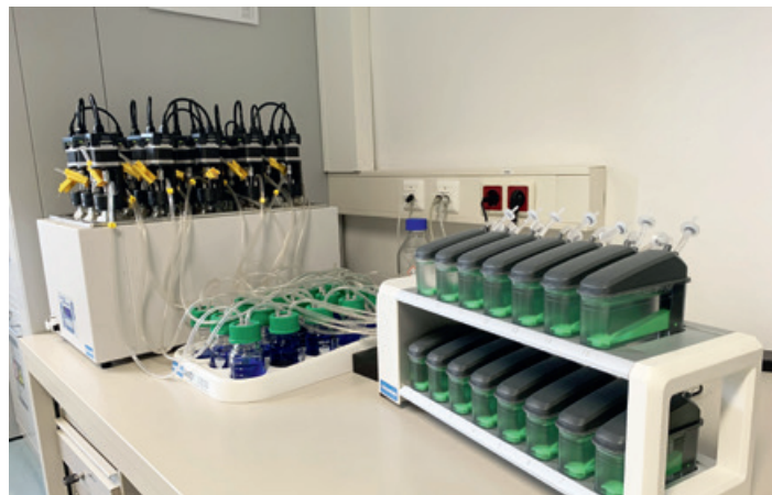
System von Parallelreaktoren zur Gasvolumenmessung bei anaeroben Fermentationen (Gas Endeavour®)
